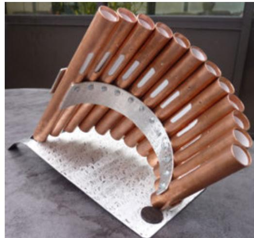
Si dans la théorie tout semble d'équerre, la réalisation pratique m'a posé beaucoup de problèmes essentiellement en raison du faible diamètre des tubes (pas facile à percer avec une grande précision) et à cause des deux sens d'utilisation. Il en résulte une certaine dispersion des taches de lumière dans plusieurs fenêtres, ce qui n'était évidemment pas le but recherché.
