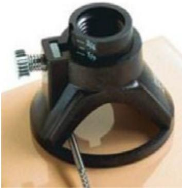
Pour les lignes horaires, la droite des équinoxes et les chiffres romains, on applique son bord circulaire sur un tasseau ou une règle. Les courbes seront gravées en se servant d'un gabarit circulaire.
